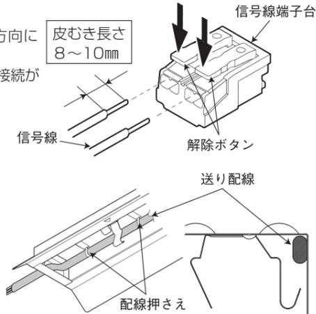
○信号線端子台に接続された信号線を取り外すときは、解除ボタンを押す。
